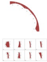
43. Les 8 modèles de briques de la torsade.
